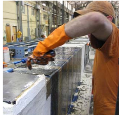
(d) Impregnating the CFRP strip
